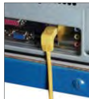
Cable hacia abajo: El capuchón del cable queda hacia abajo y el cable se inclina hacia abajo. En la ilustración: EVNSL24E-0003-90DS
