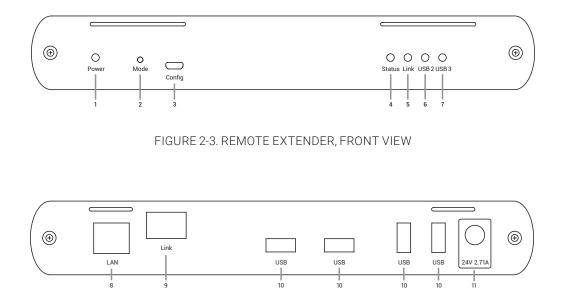
FIGURE 2-4. REMOTE EXTENDER, BACK VIEW
